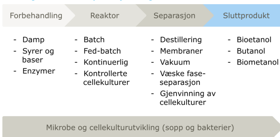
Figur 3.6 – Ulike teknologier for bioalkoholproduksjon fra lignocellulose
